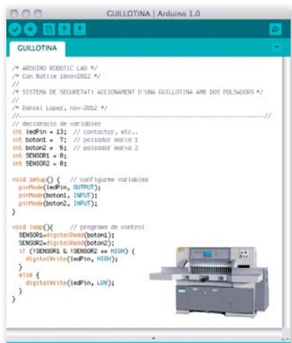
Figura 3: Control de seguridad de una guillotina de papel. Código Arduino
