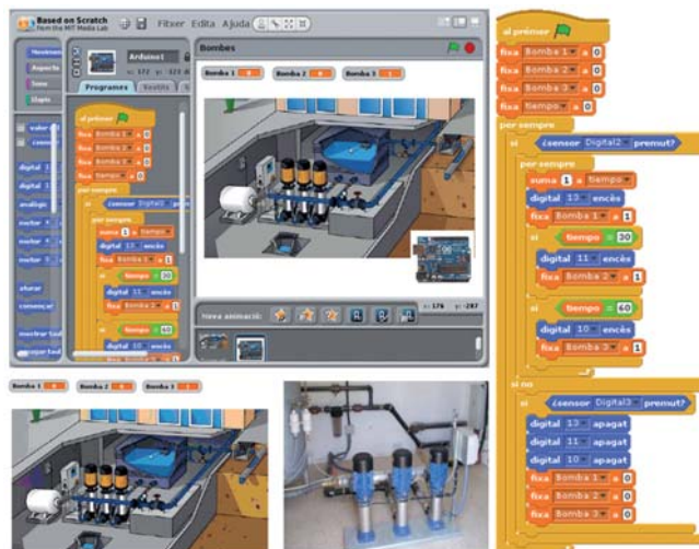
Figura 4: Control de una estación de bombeo de agua: simulación y código con S4A y Arduino
