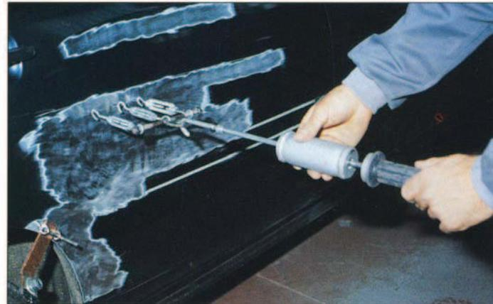
Técnicas de estirado de la chapa utilizando varias arandelas simultáneamente
