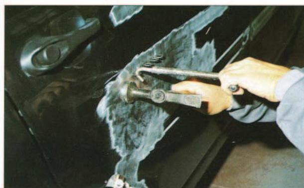
Reconformado realizado traccionando sobre las arandelas y golpeando con el martillo
