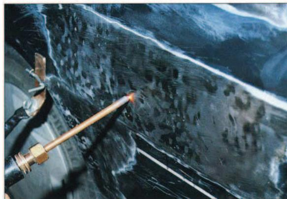
Recogido de la chapa en una superficie inestable utilizando electrodo y equipo de soldadura
