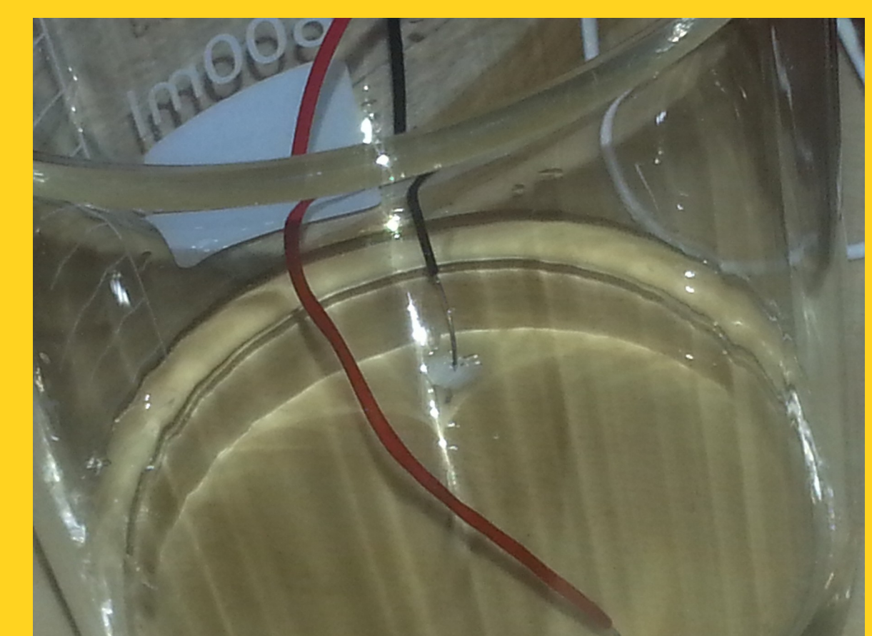
FIGURA 3 – IMATGE DEL CABLE CONNECTAT AL BORN NEGATIU DEL QUE SORTIEN BOMBOLLES
