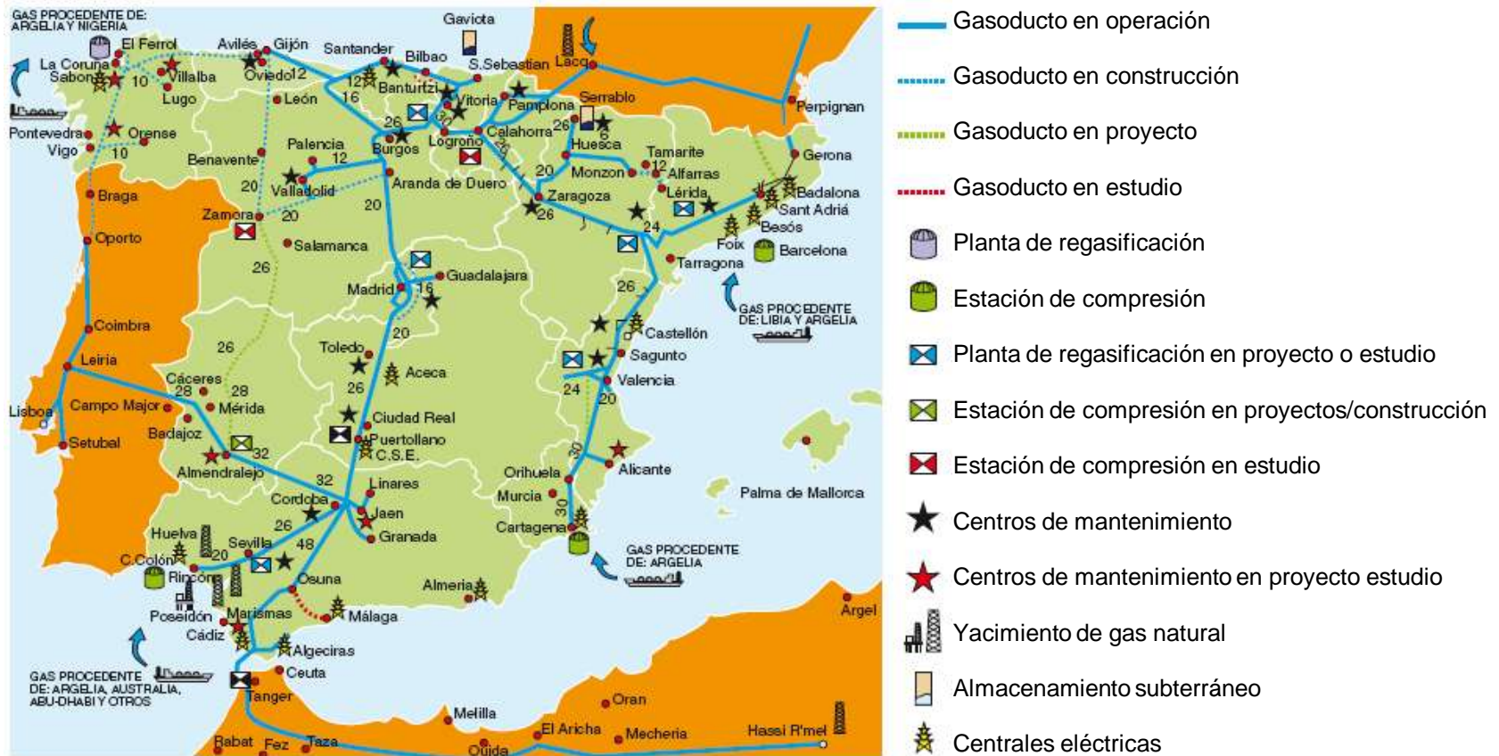
Red de gaseoductos de gas natural.
