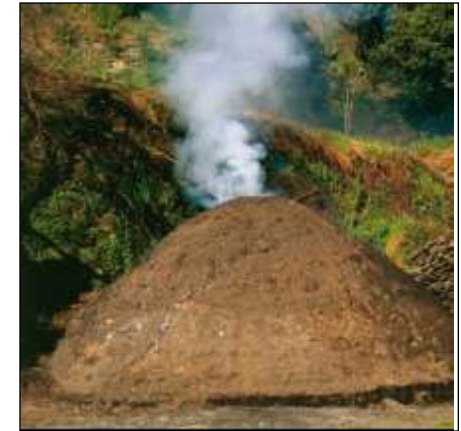
Obtención del carbón vegetal a través de la descomposición por acción del calor (pirólisis).
