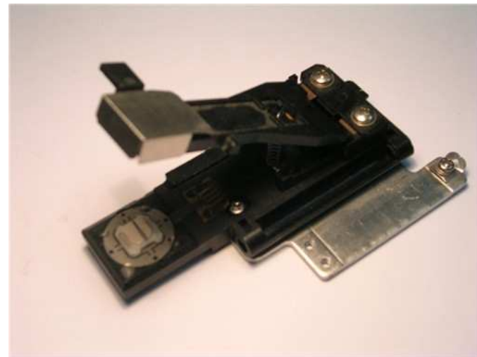
Part interior d'una disquetera per a lectura i grabació de disquets
